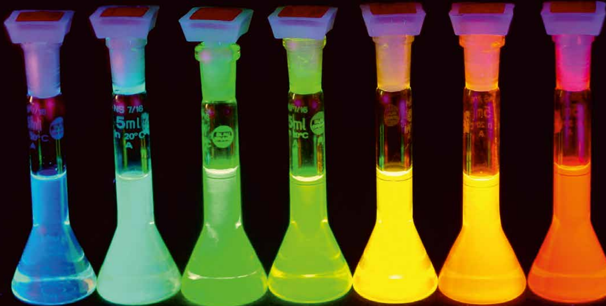
Bild: Die Lumineszenz von kolloidalen CdSe/ZnS-Nanopartikeln ist abhängig von der Partikelgrösse (links: ~2nm, rechts: ~6nm) © 2026 Dmitri V. Talapin
